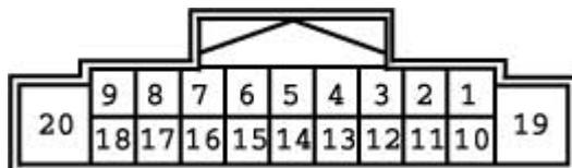
**ATENÇÃO:** AS CORES DOS FIOS DA INTERFACE NÃO CORRESPONDEM ÀS DOS FIOS DO CHICOTE DO VEÍCULO. CONECTOR VISTO DO LADO DOS PINOS, NÃO DOS FIOS.
